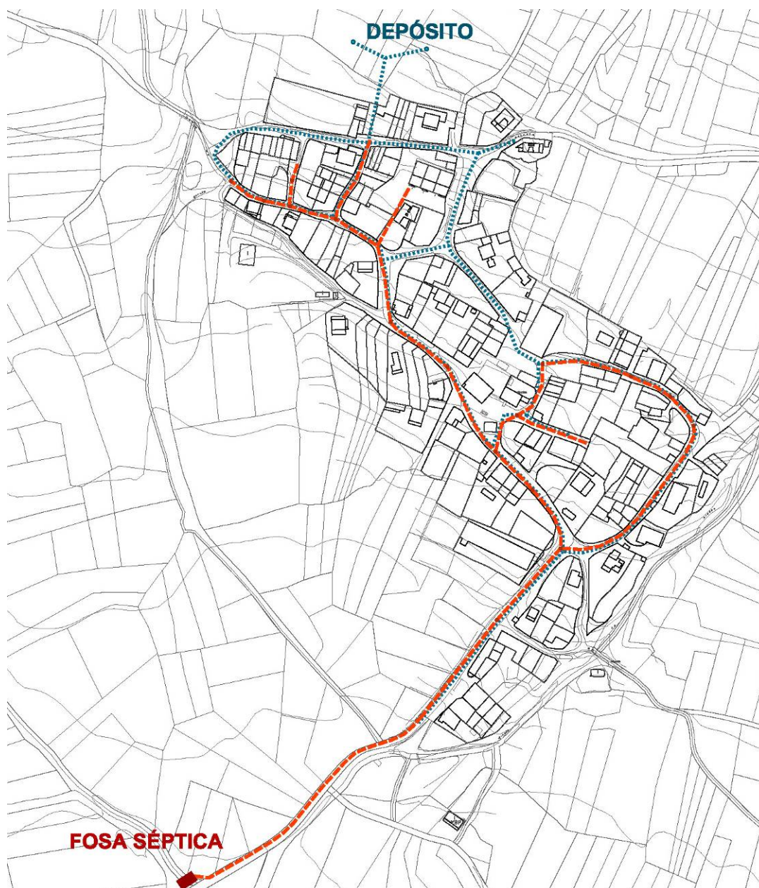
Esquema de las redes de saneamiento y abastecimiento de Denteras de la Sierra. Elaboración propia.
